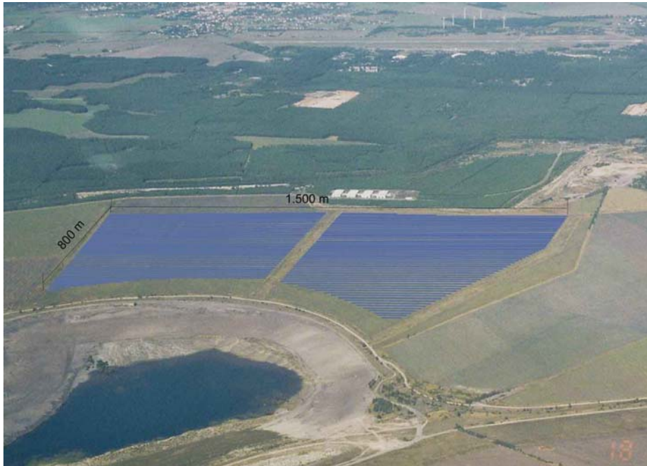
Abb. 1-1: Dimensionierung des geplanten Solarparks Finsterwalde I geplante Gesamtfläche ca. 140 ha, Anlagenfläche ca. 100 ha Fotomontage (Quelle: Dubiel 2005 / Arge PV-Monitoring 2005 b)
